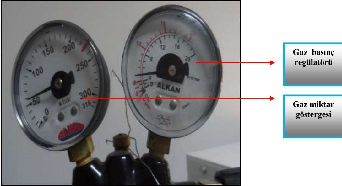
Şekil 3. Gaz tüpü basınç regülatörü ve miktar göstergesi
