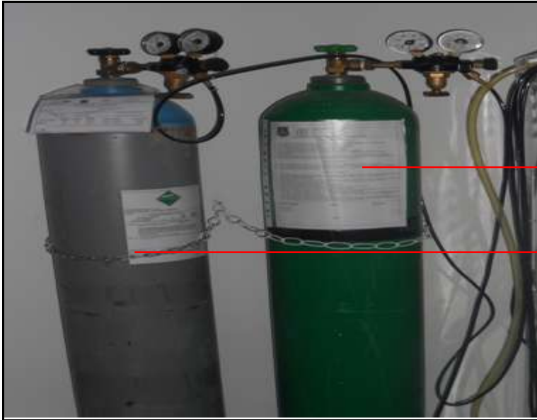
Şekil 2. Anaerop kabin uygulamalarında kullanılan gaz tüpleri
