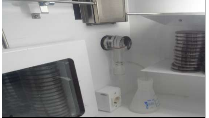
Şekil 6. Kabin içerisinde yoğunlaşan suyun toplanması
