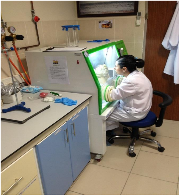
Şekil 1: Anaerobik Bakteriyoloji Laboratuvarında kurulum ve optimizasyonunu gerçekleştirdiğim Biobase marka anaerobik chamber.
