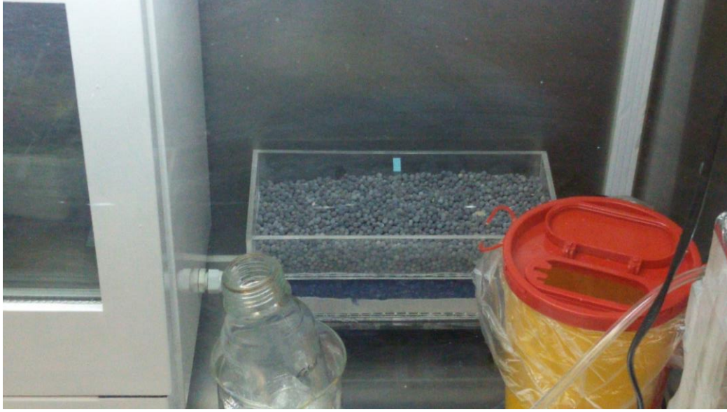
Şekil 7. Anaerobik chamber içerisindeki palladium katalizörü, silika jel ve oksijen indikatörü.
